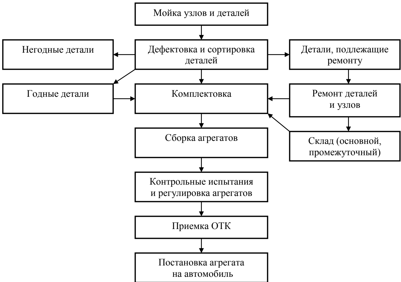
Рис. 109. Схема технологического процесса ремонта агрегатов (цеховые работы)
