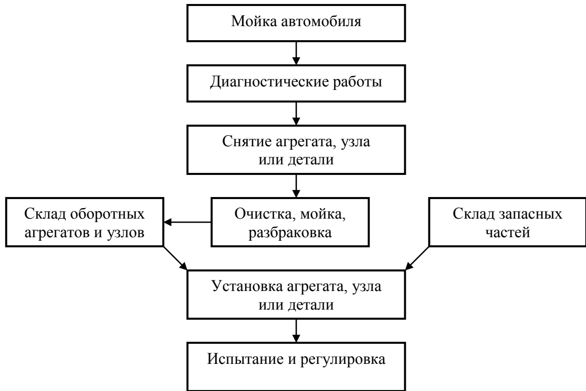
Рис. 108. Схема технологического процесса ремонта автомобилей в процессе их эксплуатации (постовые работы)
