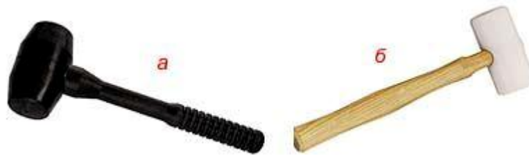
Рис. 34. Молотки из пластических масс: а – целиком из пластмассы; б – с деревянной ручкой
