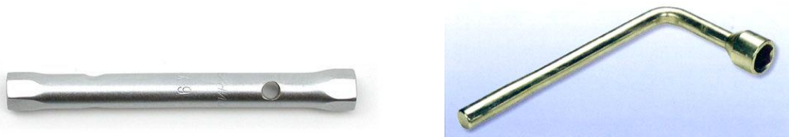
Рис. 26. Торцовые гаечные ключи: а – прямой трубчатый; б – изогнутый
