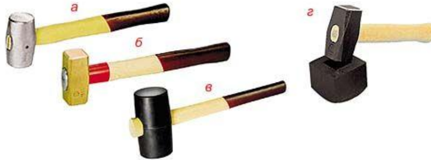
Рис. 33. Молотки из цветных металлов и резины: а – свинцовый молоток; б – медный молоток; в – резиновый молоток; г – резиновый наконечник (накостыльник) для кувалды
