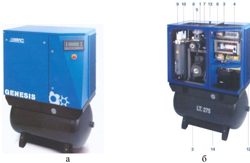
Рис. 48. Компактная компрессорная станция: а – внешний вид; б – устройство; 1 – воздушная головка; 2 – электродвигатель; 3 – блок управления; 4 – стартер типа «звезда–треугольник»; 5 – блок подготовки сжатого воздуха; 6 – частотный инвертер; 7 – электрический вентилятор; 8 – всасывающий фильтр; 9 – масляный сепаратор; 10 – масляный фильтр; 11 – впускной клапан; 12 – панель пре-фильтра; 13 – воздушно-масляный охладитель; 14 – ресивер
