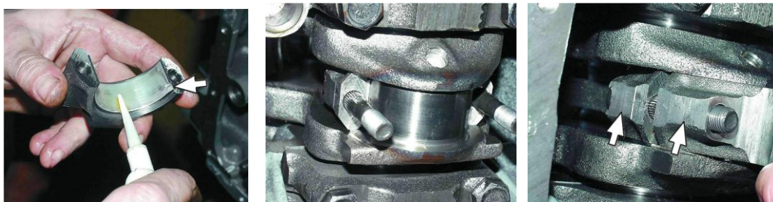
Рис. 59. Установка нижней головки шатуна на шейку коленчатого вала
