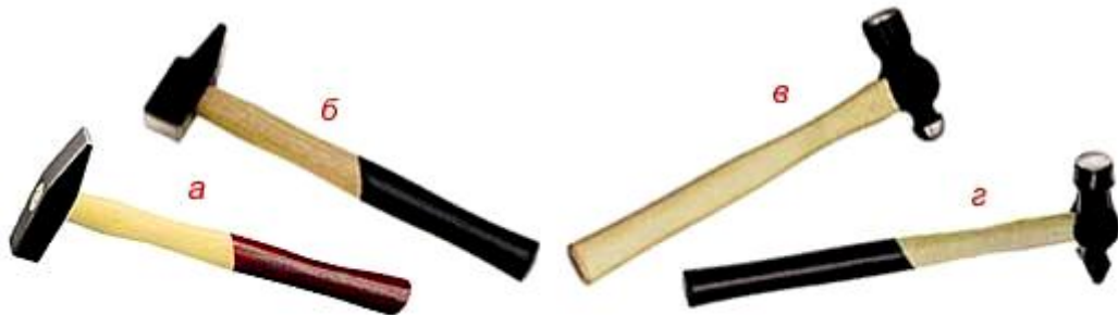
Рис. 32. Типы молотков общего назначения: а – германский; б – французский; в – британский; г – американский
