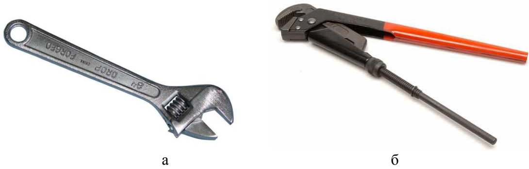
Рис. 28. Регулируемые ключи: а – разводной, б – трубный
