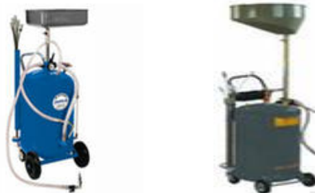
Рис. 22. Установки для удаления отработанного масла
