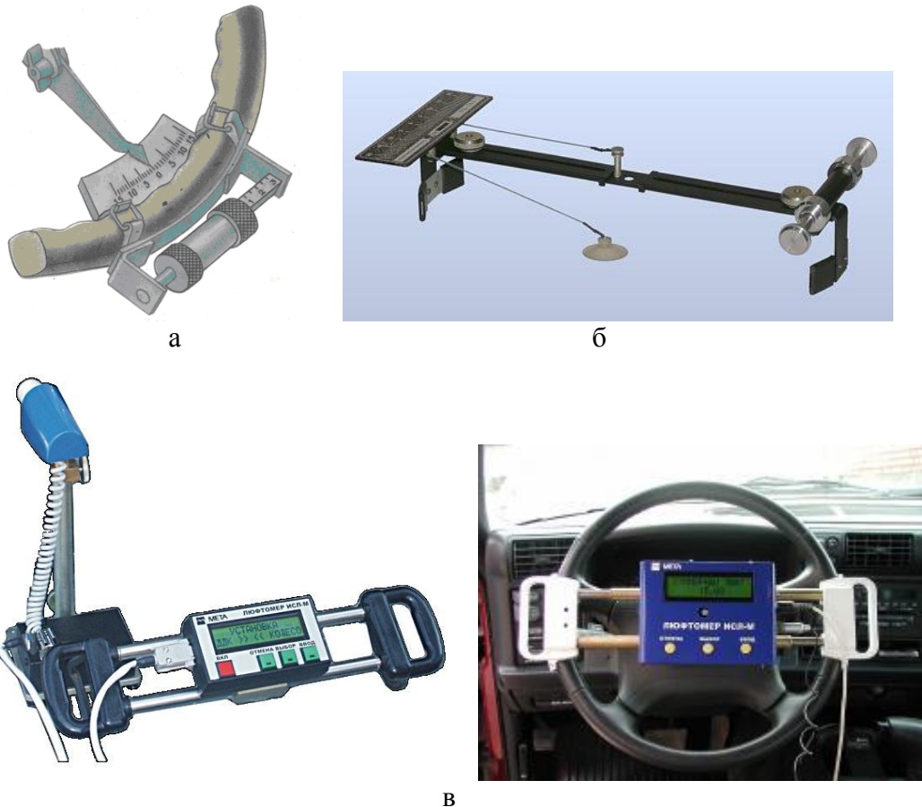
Рис. 85. Приборы для измерения свободного хода рулевого колеса: а – НИИАТ К-402; б – люфтомер-динамометр ЛД-101; в – измеритель суммарного люфта рулевого управления транспортных средств ИСЛ-М
