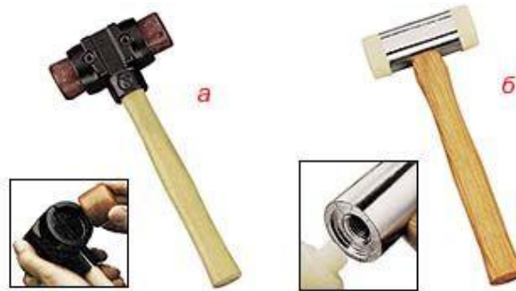
Рис. 36. Молотки со сменными бойками: а – молоток с зажимаемыми бойками; б – молоток с резьбовым креплением бойков
