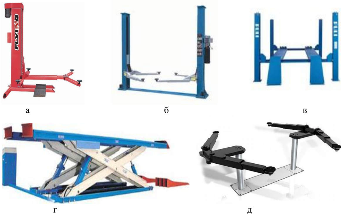
Рис. 21. Разновидности автомобильных подъемников: а – одностоечный; б – двухстоечный; в – четырехстоечный; г – параллелограммный (ножничный); д – плунжерный
