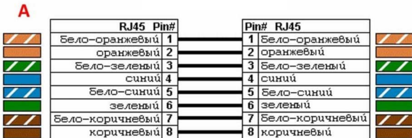
Рисунок 1 – Схема распределения проводников при прямом обжиге
