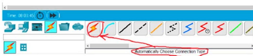
Рисунок 11 – Автоматический выбор кабеля в Cisco Packet Tracer
