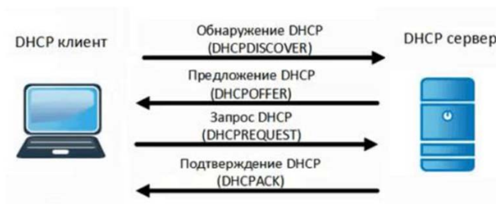
Рисунок 4 - Принципы работы протокола DHCP
