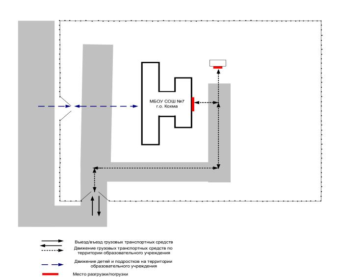
III. Схема организации дорожного движения в непосредственной близости от образовательного учреждения с размещением соответствующих технических средств, маршруты движения детей и расположение парковочных мест
